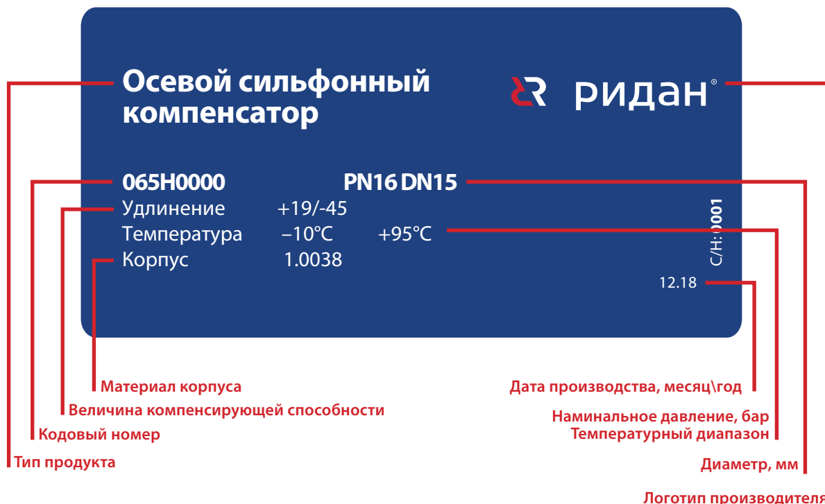
Рисунок 5 – Этикетка на компенсаторе
